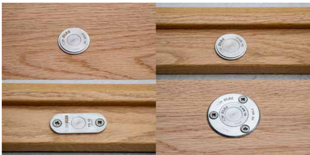
Olda FSR 12 (överst vänster) respektive Olda FSR 15 (överst höger) limmade i ett trägolv och tröskel. Traditionell tröskelmontering av Olda FS 12 (underst vänster) samt skruvmontering av Olda FSR 15 tillsammans med Olda FSR 30. Samtliga montage har en höjd av 2 mm.
