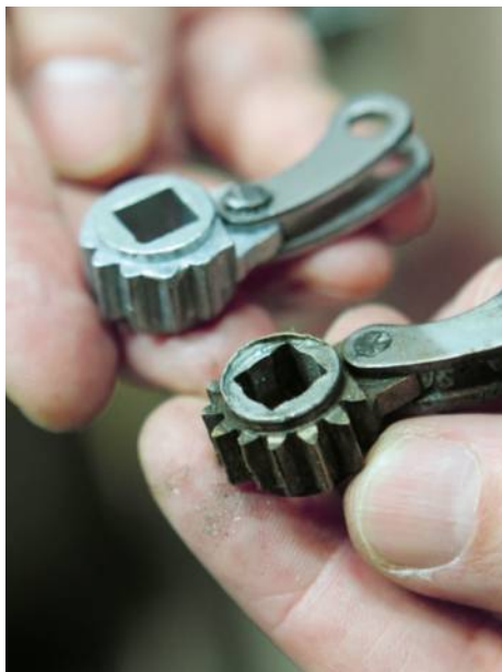
Det som oftast går sönder är roddaren. Låset AB har gjutformarna och tillverkar nya alltefter behov.
