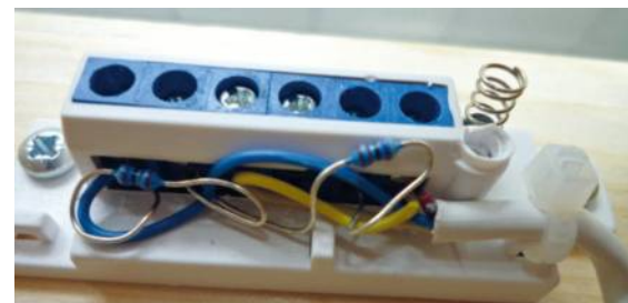
KONTAKT. Inkoppling av magnetkontakt.
