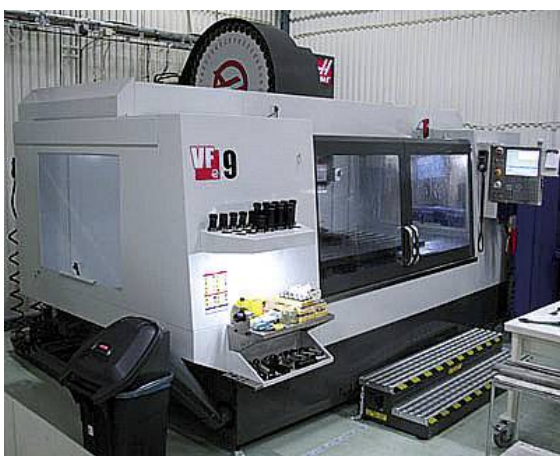
FULL FRÄS. Treaxliga flerooperationsfräsen Haas VF9.
