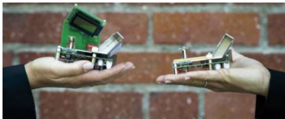
Till vänster Sanibox myntränna med display och räkneverk Till höger Sanibox myntränna utan display.
